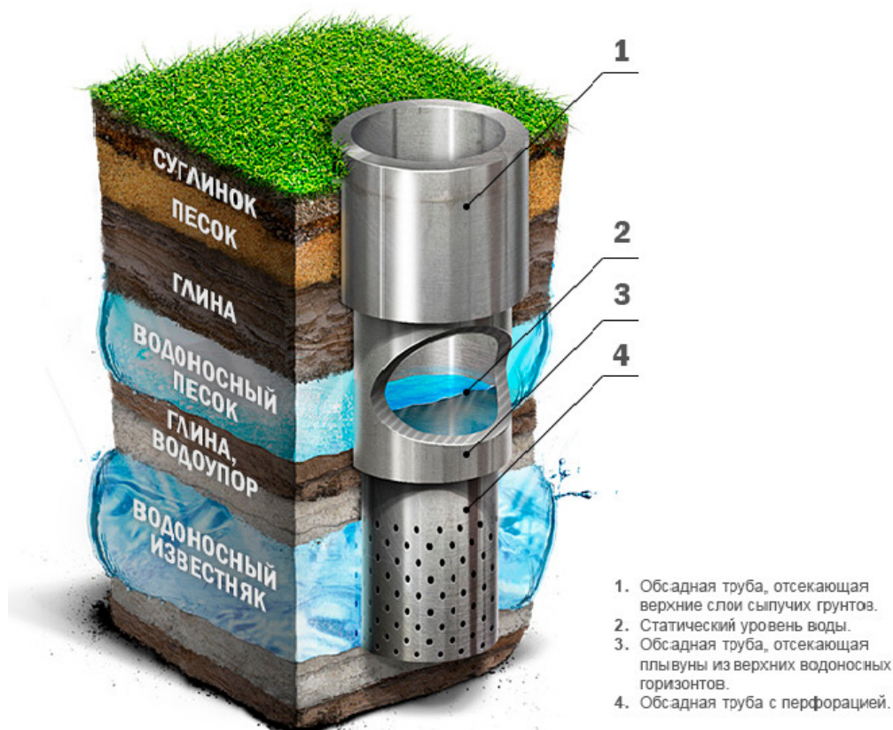
Рис. 4.1. Конструкция артезианской скважины
